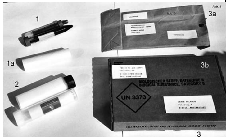
Abbildung 5: Verpackung nach P650 für Kategorie B 1 = Probenröhrchen, 1a = saugfähiges Material; 2 = Schutzgefäß; 3 = Außenverpackung, 3a = Versandhülle, 3b = formstabile Faltschachtel
